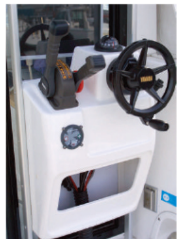
アフトコックピットにある2ステーションボックスに位置したパウスラスター用のタッチコントロール。スラスターも2箇所操縦、まさしく手前船頭用の設備です。
