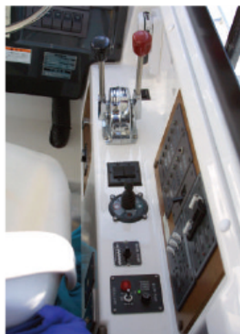
室内の運転席コントロール部分。前からエンジンコントロール、トリムタブのコントロール、そしてジョイスティック型のパウスラスターのコントロールです。
