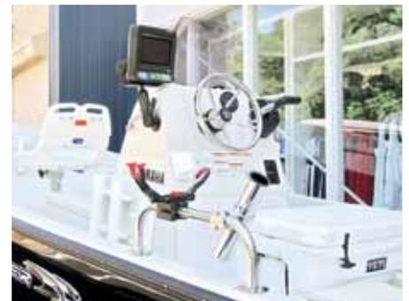
転落防止で付けたトップレール用ハンドルを利用して、チビラークポールタイプ、受太郎DXポールタイプ、そしてトローリング用ポールタイプロッドホルダーFig1215を装備しました。
