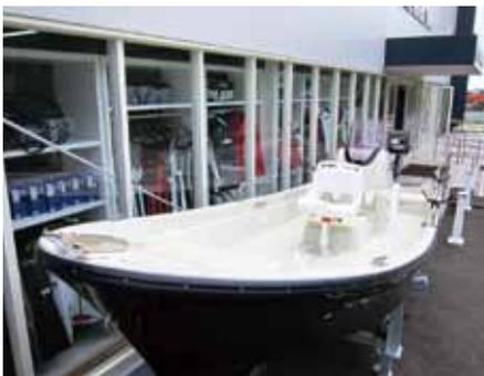
パウ先端にはキングスターボードで取り付け部分のスペーサーを作り、ステンレス製のパウローラーLW-61を装備しました。クリートはステンレスクリート150mmを両舷に付けています。
