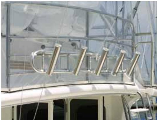
フライングブリッジのバルビットを利用してアルミ製5連タイプのロッドラックが装備されました。後付ですがバルビットとボルトナットで固定されているので130ポンドのタックルでもOKです。
