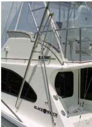
SCHAEFER社のアウトリガーホルダーLX28-CとFMSアルミ+FRPポールNo.2S、そしてハリヤードラインセットD-1でシステムを完成させています。このオーナーはアルミ+FRPポールのよき理解者で、アルミの硬さとFRPの弾力性を併せ持ち、強固で耐久性に優れたアルミとFRPの両者の利点を総合させたアウトリガーポールとして長年使い続けていただいています。
