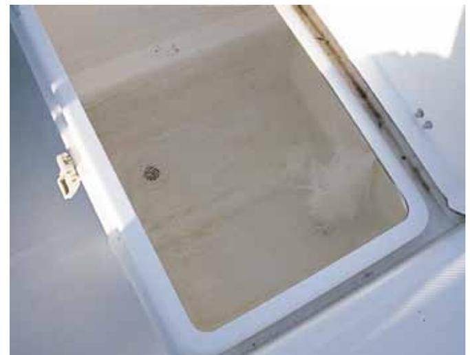
実際このようなイケスは、フィッシングをしている時、低速で走行している時だけ有効で走行中はスキャパーにフタをして使用しなければならない、条件付イケス設備ということになります。
