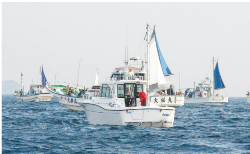
ヤマハFR32。レジャー船ですが大型遊漁船団の端で同じ向きで流すことができている。しかし、船体が軽く水面下の噴水が浅いのでエンジンで制御しないと風には速く流されてしまいます。
