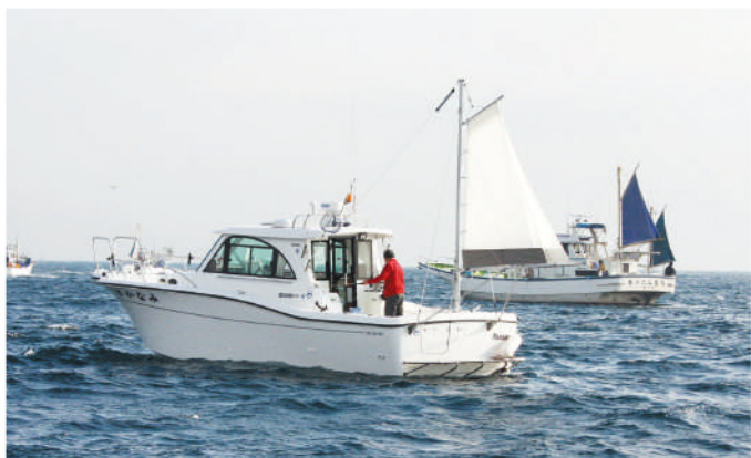
大型遊漁船と比較するとレジャー船のセイル面積はかなり大きなサイズになっています。その理由は船体が軽く水面下の噴水が浅いので風上に向かないからです。
