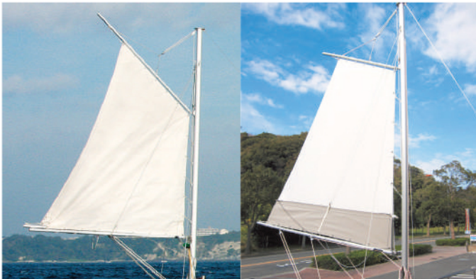
帆布を利用して50数年前からある形状 セイルクロスを利用して形状を見直した物 ※帆布の数字はFMSマリンカタログP.93プロ用漁船セイルサイズを記しています。
