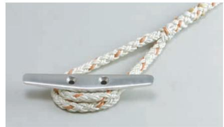
栈橋などの係船クリートに固定する場合、クリートに1周巻いて固定すれば係船索がゆるんでもスポーンと抜けないですみます。
